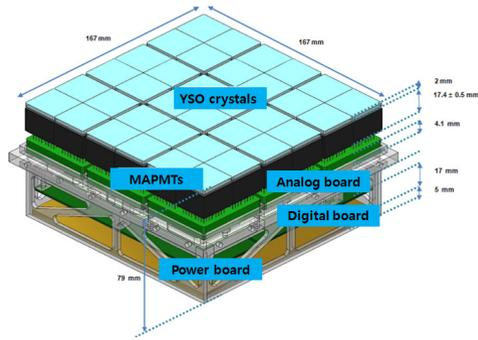
Fig. 2. The UBAT detector.
